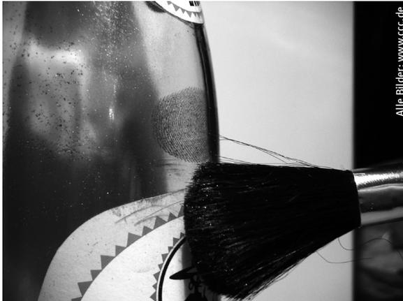
Bild 1: Sichtbarmachen mit Graphitpulver
